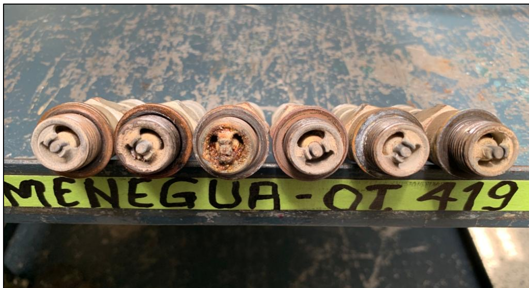
Fotografía No. 5 – Condición de seis (6) de las ocho (8) bujías instaladas.
